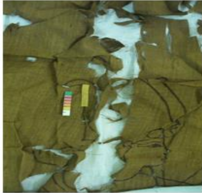
شكل (16) اختبار ثبات الأحبار تجاه الماء المقطر والاس الهيدروجينى لمنطقة الأحبار... تصوير الباحث
