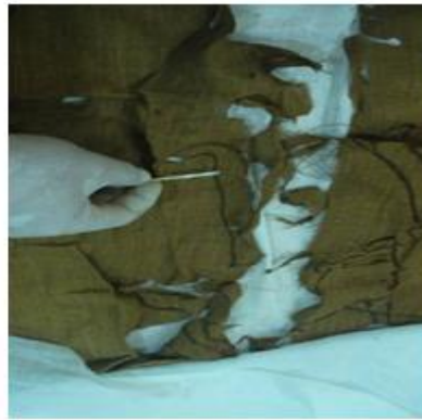
شكل (16) اختبار ثبات الأحبار تجاه الماء المقطر والاس الهيدروجينى لمنطقة الأحبار... تصوير الباحث
