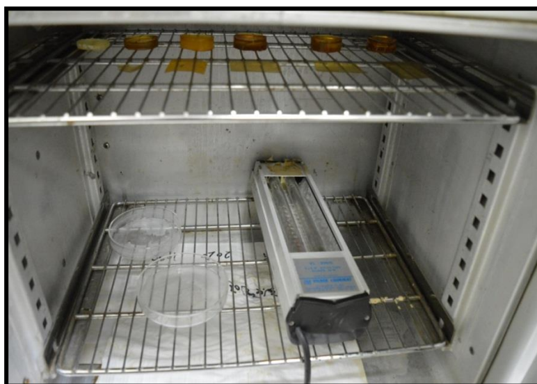
صورة (10) للعينات أثناء التقادم بـ (الحرارة والأشعة فوق البنفسجية مع الرطوبة)
