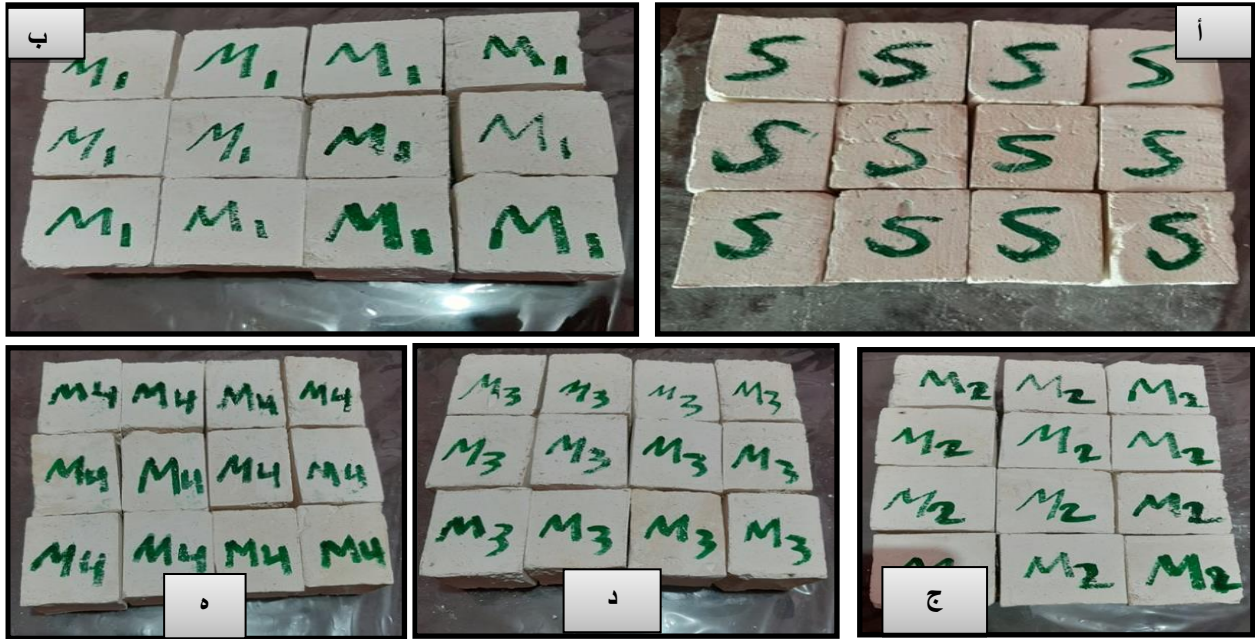
صورة رقم (3): مجموعة مكعبات المونة المختلفة المعدة للتقييم والدراسة التجريبية.
